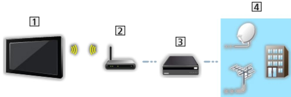
1 Integriertes Wireless-LAN (Rückseite des Fernsehers)
