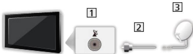
**1** Eingangsbuchse IN 1 für Satellitensignal
