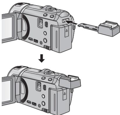
Zum Abnehmen des Blitzschuh-Adapters schieben Sie den **SHOE ADAPTOR RELEASE**-Hebel auf, halten Sie ihn in dieser Position und nehmen Sie den Blitzschuh-Adapter ab.
