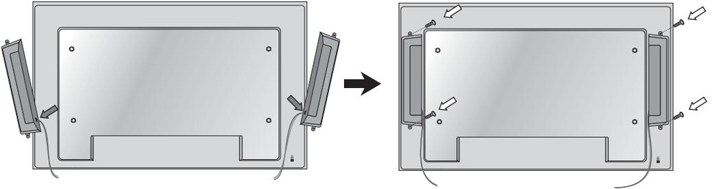
Fixieren Sie die Lautsprecherkabel nach dem Anbringen der Lautsprecher mit den Halterungen und Kabelbindern.
