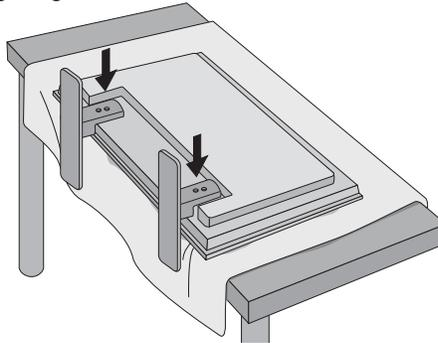
3. Befestigen Sie den Standfuß mit den Schrauben auf der Rückseite des Fernsehers, wie in der Abbildung gezeigt.
