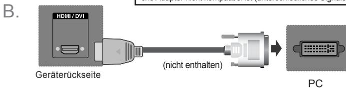
\* Um die Betriebsrichtlinien für dieses Gerät einzuhalten, müssen abgeschirmte Signalkabel (15-poliges D-Sub-Kabel, HDMI-DVI-Kabel) mit Ferritkern verwendet werden.
