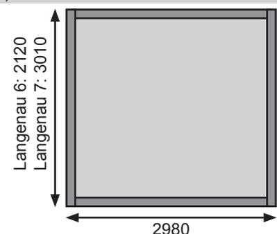
Fundamentplan (in mm) bei Aufbau mit Fußboden:
