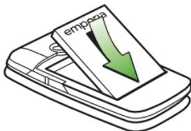
Setzen Sie den Akku so ein, dass sich die goldenen Kontakte (Akku und Telefon) rechts oben berühren.
