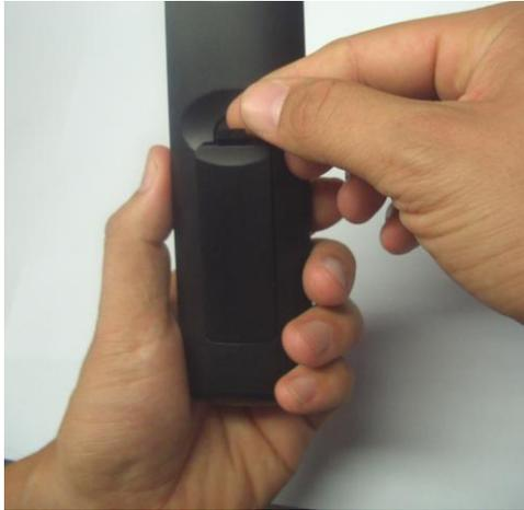
⇒ Legen Sie zwei Batterien unter Beachtung der vorgegebenen Polarität in das Batteriefach ein.
