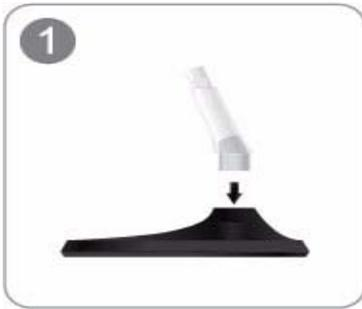
Setzen Sie den Standfußanschluss in der Richtung in den Standfuß, die in der Abbildung gezeigt ist.
