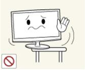
Achten Sie beim Aufstellen des Geräts in einem Schrank oder auf einem Regal darauf, dass die Vorderseite des Geräts nicht über die Vorderkante herausragt.
