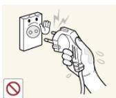
Berühren Sie den Netzstecker beim Einstecken und Trennen der Verbindung nicht mit feuchten Händen.
