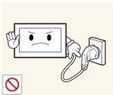
Ziehen Sie den Netzstecker niemals bei eingeschaltetem Monitor aus der Steckdose.
