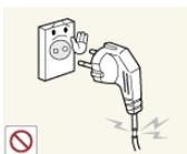
Verwenden Sie weder beschädigte Steckdosen noch defekte Netzkabel oder Stecker.
