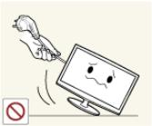
Ziehen Sie niemals am Strom- oder Antennenkabel, um das Gerät zu bewegen.
