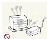
Halten Sie das Netzteil von anderen Wärmequellen entfernt.
