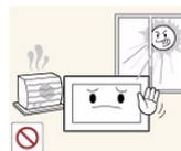
Stellen Sie das Gerät nicht in der Nähe von Feuerstellen oder Heizkörpern bzw. an Orten auf, wo es direkter Sonneneinstrahlung ausgesetzt ist.
