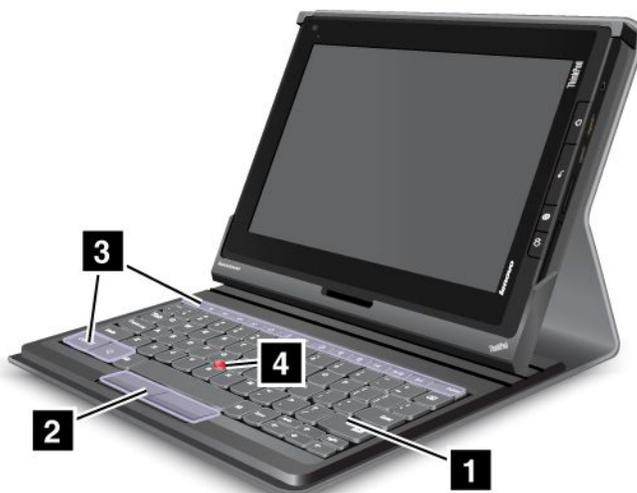
Abbildung 9. Überblick über das ThinkPad Tablet-Tastatur-Dockgehäuse
