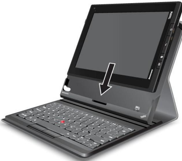
Abbildung 13. Tablet in das Tastatur-Dockgehäuse einsetzen
