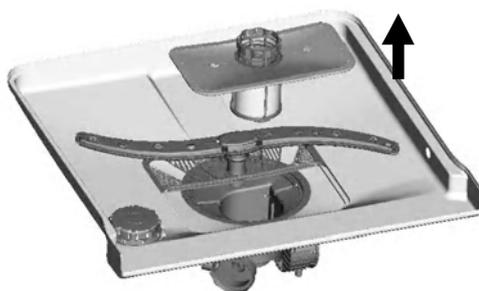
Schritt 2: Heben Sie die Filtereinheit heraus,
