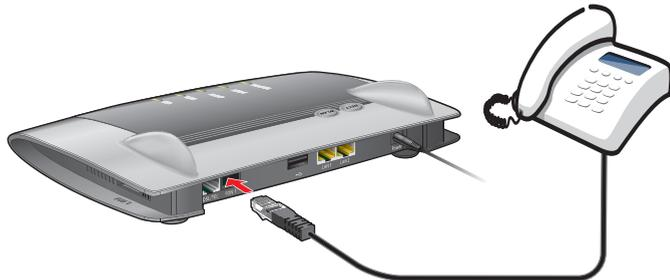
Anschluss eines analogen Telefons mit RJ11-Stecker
