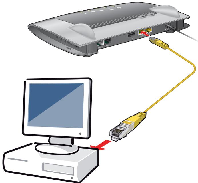
Anschluss eines Computers mit einem Netzwerkkabel
