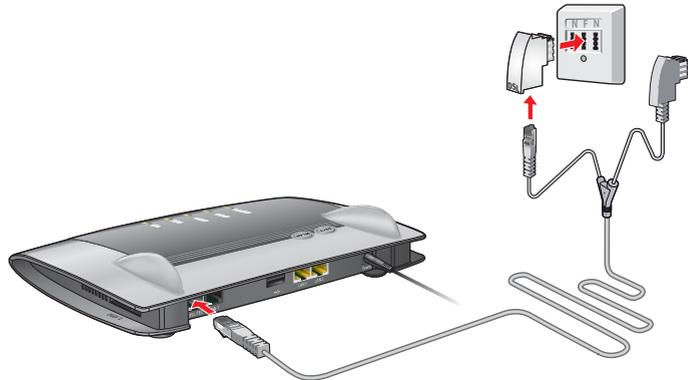
Anschluss mit DSL-/Telefonkabel und DSL-Adapter
