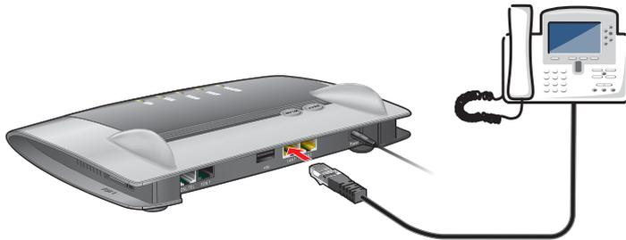
IP-Telefon an LAN-Buchse der FRITZ!Box anschließen
