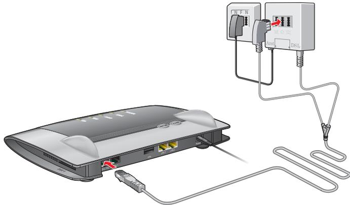
Anschluss am analogen Telefonanschluss über den DSL-Splitter
