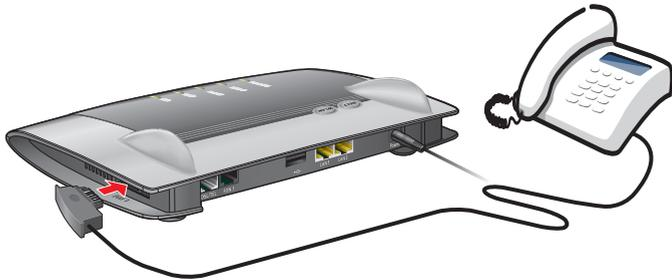
Anschluss eines analogen Telefons mit TAE-Stecker
