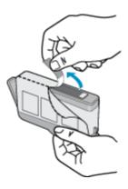
**b**. Drehen Sie die orangefarbene Kappe, um diese zu entfernen. Sie müssen ggf. kräftig drehen, um die Kappe zu entfernen.
