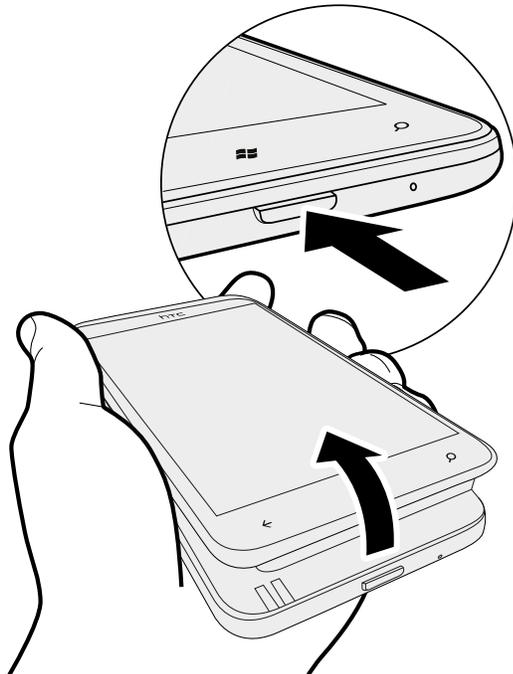
Damit wird der untere Teil des Telefons von der Rückabdeckung getrennt.
