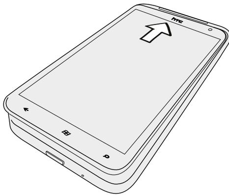
3. Drücken Sie auf das Telefon, um die Abdeckung zu befestigen. Die Rückseitenabdeckung ist gesichert, sobald sie eingerastet ist.
