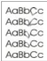
Bei diesem Verfahren wird die Trommel in der Tonerpatrone gereinigt. Verwenden Sie dieses Verfahren, wenn die Ausdrücke verschwommen, verblaßt oder verschmiert aussehen. Der Reinigungsprozeß dauert ca. 10 Minuten. Weitere Informationen finden Sie unter „Starten des Reinigungsvorgangs“ auf Seite 80.
