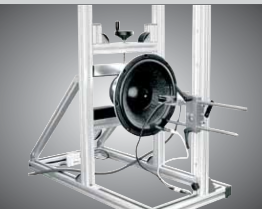
Laser-gestütztes Klippel®-System Laser-supported Klippel® system
