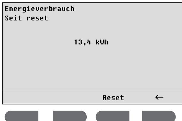
Im oben abgebildeten Display ist beispielhaft der **Energieverbrauch** abgebildet. Unabhängig davon, ob Sie die Anzeige des Energie- oder Wasserverbrauchs zurücksetzen wollen, ist der Vorgang identisch.
