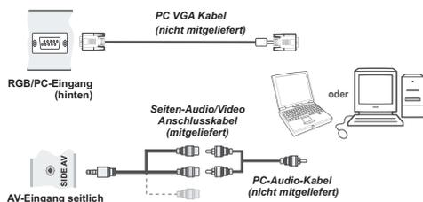
Stellen Sie zuerst die Ausgabeauflösung am PC ein, bevor Sie diesen an das TV-Gerät anschließen. Für ein optimales Bild verwenden Sie bitte die Funktion PC-Einstellung.
