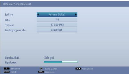
Nach Auswahl des Suchtyps **Digital Antenne** können Sie mit den Zifferntasten die Multiplexnummer oder die Frequenz eingeben und dann **OK** drücken, um die Suche zu starten.
