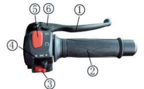
Beim Ziehen dieses Hebels wird die Vorder- radbremse aktiviert.
