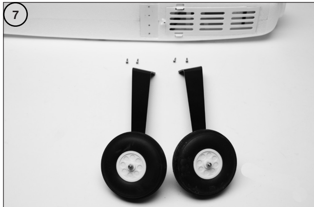
Bild 7 - Die Abbildung zeigt die benötigten Teile für die Montage des Fahrwerks.
