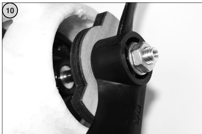
Bild 10 - Die Abbildung zeigt die fertig montierte Luftschraube mit Luftschraubenmitnehmer und Spinnerrückwand.
