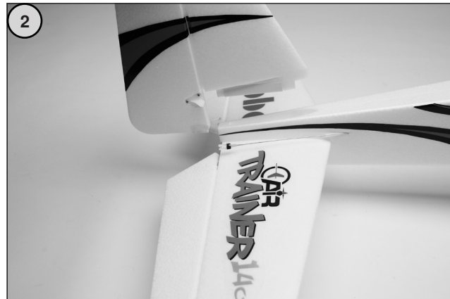
Bild 2 - Schieben Sie das Höhenleitwerk von hinten in den Aufnahmeschlitz am Rumpfende ein. Achten Sie darauf, dass sich die Montagebohrungen für das Ruderhorn des Höhenruders auf der linken Rumpfseite befinden. Stecken Sie von oben das Seitenleitwerk in den Rumpf ein. Schrauben Sie die Gabelköpfe auf das Anlenkgestänge für das Höhen- und Seitenruder.
