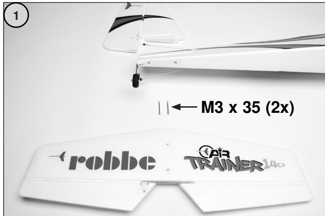
Bild 1 - Das Bild zeigt die benötigten Teile zum Einbau des Seiten- und Höhenleitwerks.
