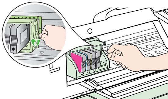
4. Nehmen Sie den Druckkopf heraus, indem Sie ihn anheben und aus dem Drucker herausziehen.
