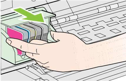
5. Vergewissern Sie sich, dass der Hebel hochgezogen ist, und setzen Sie dann den Druckkopf wieder ein.
