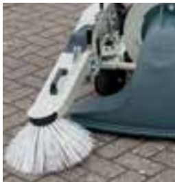
Optional mit Seitenbesen: fegen und aufsaugen
