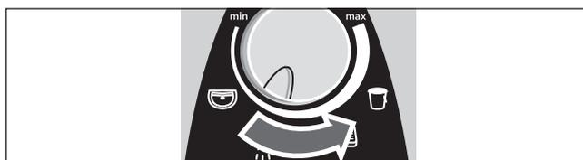
Wanneer bij geheel geopende warmwaterkraan geen hogere temperatuur wordt bereikt, stroomt meer water dan het doorstroomtoestel op basis van zijn capaciteit kan verwarmen. In dit geval moet de warmwaterkraan iets worden dichtgedraaid.
