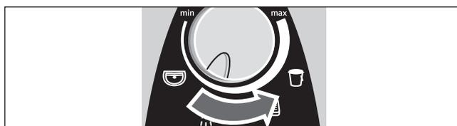
Jeśli przy maksymalnym odkręceniu kurka nie można uzyskać wyższej temperatury, oznacza to, że przez urządzenie przepływa więcej wody, niż ogrzewacz jest zdolny ogrzać. W tym przypadku należy zmniejszyć strumień wody.
