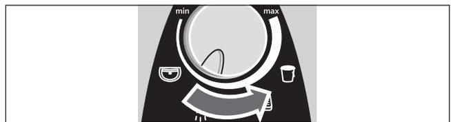
Wird bei ganz geöffnetem Warmwasserhahn eine höhere Temperatur nicht erreicht, so fließt mehr Wasser, als der Durchlauferhitzer aufgrund seiner Leistung erwärmen kann. In diesem Fall muss der Warmwasserhahn etwas geschlossen werden.
