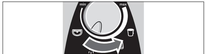
Si la température de l'eau n'est pas suffisamment élevée lorsque le robinet est complètement ouvert, cela indique que le débit d'eau qui traverse le chauffe-eau est plus important que celui que la puissance du chauffe-eau permet de chauffer. Pour obtenir une eau plus chaude, il convient dans ce cas de fermer quelque peu le robinet pour réduire le débit.
