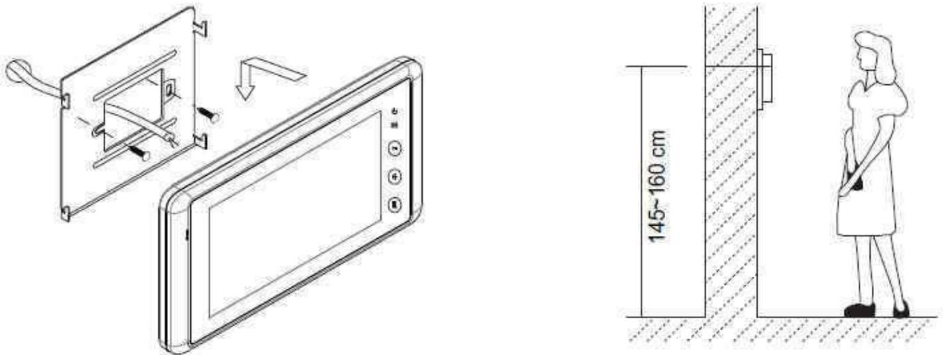
Die optimale Montagehöhe für Ihren Monitor beträgt 145-160 cm . Befestigen Sie die Halteplatte an der Wand der Monitor wird nun von oben eingerastet!
