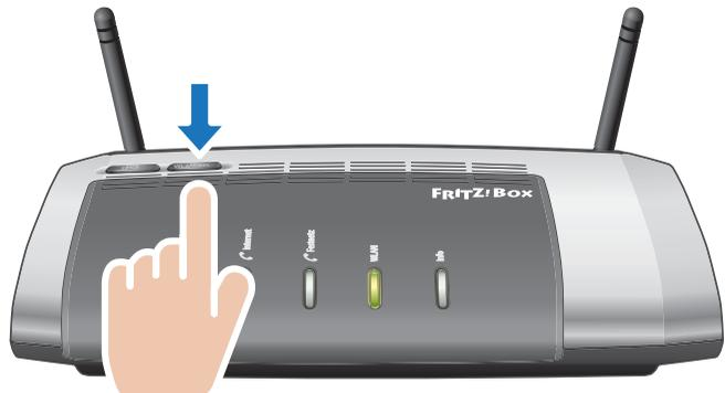
2. Wenn die Leuchtdiode „WLAN“ blinkt, starten Sie am WLAN-Gerät WPS. Sie haben dafür 2 Minuten Zeit.
