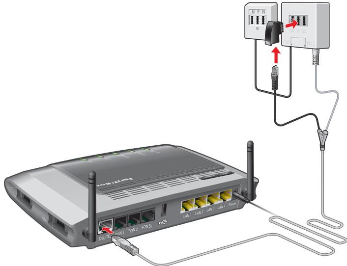
Anschluss am analogen Telefonanschluss über den DSL-Splitter
