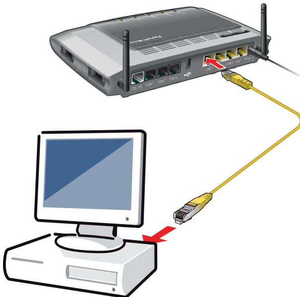
Anschluss eines Computers mit einem Networkkabel
