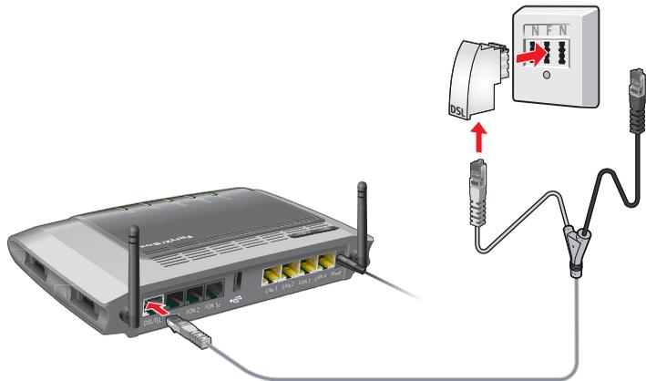
Anschluss mit DSL-/Telefonkabel und DSL-Adapter
