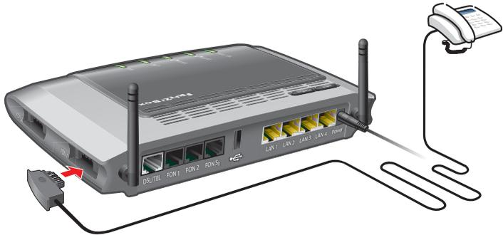
Anschluss eines analogen Telefons mit TAE-Stecker
