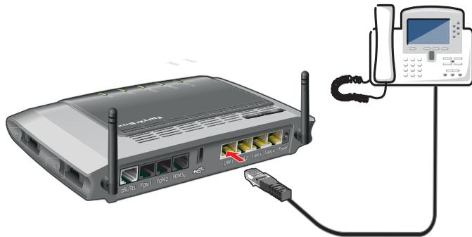
IP-Telefon an LAN-Buchse der FRITZ!Box anschließen
