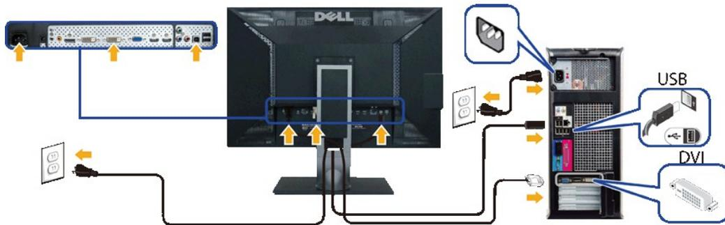
**📌 HINWEIS:** Ihr Monitor unterstützt zwei DVI-Anschlüsse. Sie können die Eingangsquelle (DVI-D 1 oder DVI-D 2) über die Eingangsquellenauswahl-Option im OSD-Menü auswählen.
