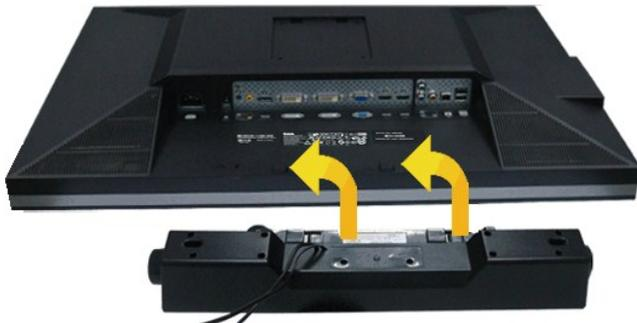
1. Hängen Sie die beiden Schlitzlöcher an der Rückseite der Soundbar in die beiden Nasen im unteren Teil der Rückseite des Monitors ein.
