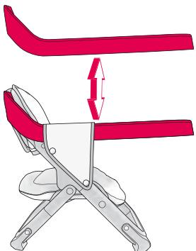
Um das Tablett abzunehmen, klappen Sie zunächst das Polster der Rückenlehne nach hinten und öffnen Sie die Druckknöpfe der seitlichen Laschen des Bezuges der Sitzfläche. Lösen Sie dann die Verriegelung (05) an der Rückseite der Rückenlehne und ziehen Sie das Tablett nach oben von der Rückenlehne ab.
