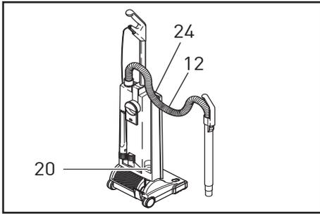
Zur Benutzung des Teleskopschlauchs (12) das Gerät immer in die aufrechte Position stellen. Dann das Saugrohr nach oben herausziehen und den Schlauch spannen, bis er einrastet. Zum Zurückstecken das Teleskoprohr erst in das Gelenk (20) einführen und es dann mit dem Griff auf den Nocken (24) am Filtergehäuse stecken. Der Schlauch gleitet dann zurück und kann auch ohne das Saugrohr benutzt werden. Die Saugdüsen (16,17) passen auf das Saugrohr und den Schlauch.
