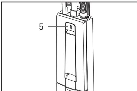
Zum Wechseln der Filtertüte das Deckelschloß (5) öffnen. Dann die Filtertüte wechseln, wie auf deren Vorderseite illustriert. Dabei sicherstellen, dass die grüne Platte (28) auf beiden Seiten richtig in die Führung des Filterhalters (29) geschoben und eingerastet ist. Gebrauchte Filtertüten können mit Deckeln verschlossen werden, die jeder SEBO Filterbox und Service-Box beiliegen.
