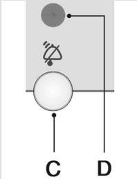
Bei überhöhter Innentemperatur wird ein **ununterbrochenes akustisches Signal** ausgelöst und das rote Lämpchen blinkt (D).
