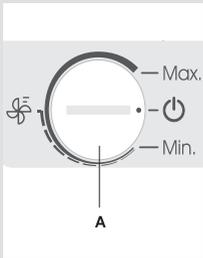
Schalten Sie das Gerät ein, indem Sie den Drehknopf **A** im Uhrzeigersinn gegen die Markierung **Max.** drehen. Das Gerät wird abgeschaltet, wenn sich der Punkt des Drehknopfes bei der Markierung
