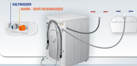
**HINWEISE:** Bei Verwendung von Warmwasser sollte die Warmwassertemperatur am Hahn der Warmwasserleitung nicht mehr als 60°C betragen. Sie waschen besonders günstig, wenn das Warmwasser durch regenerative Energien (z.B. Solarenergie) erwärmt wird.
