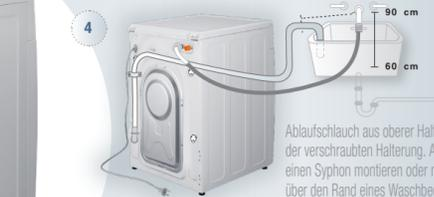
Ablaufschlauch aus oberer Halterung lösen, jedoch nicht aus der verschraubten Halterung. Ablaufschlauch entweder an einen Siphon montieren oder mit der Ablaufschlauchführung über den Rand eines Waschbeckens einhängen.
