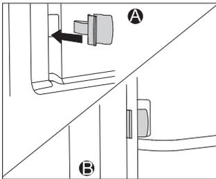
Stecken Sie bei der Montage der Teleskopausziehführungen (vollständiges Herausziehen) mit katalytischer Garraumauskleidung die beigelegten Schnapper in die unteren Öffnungen auf der Backofenwand. Stecken Sie darauf die Führungen in die Schnapper ein. Die Schnapper dienen zur besseren Befestigung der Führungen.
