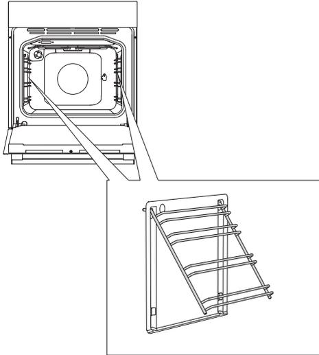
Entfernen Sie die Draht- bzw. Ausziehführungen.
